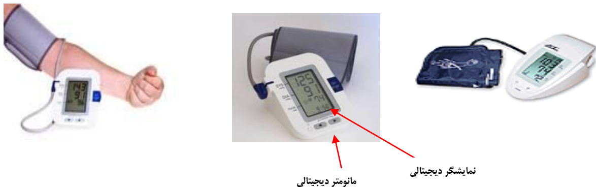
شکل ۸: دستگاه فشارسنج دیجیتالی (مخصوص بازو) (digital monitor)
